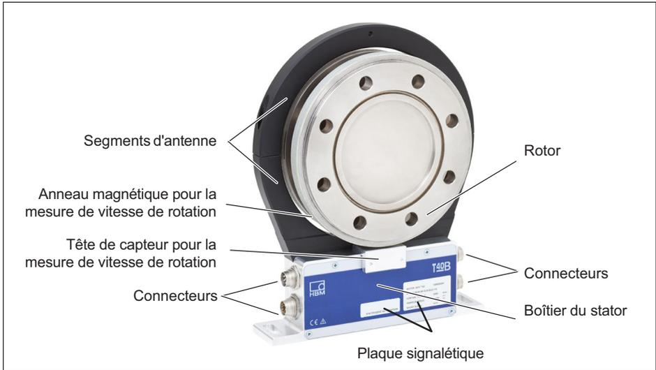
Fig. 4.2 Structure mécanique avec système de mesure de vitesse de rotation
