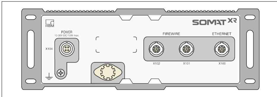
所有的 MX 模块都有一个类似的外壳背板，配有电源接口、两个火线接口和一个以太网接口。
