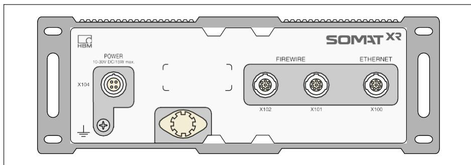
Tutti i moduli MX sono dotati di una parete posteriore della custodia simile con collegamento alla rete, due collegamenti FireWire e un collegamento Ethernet.
