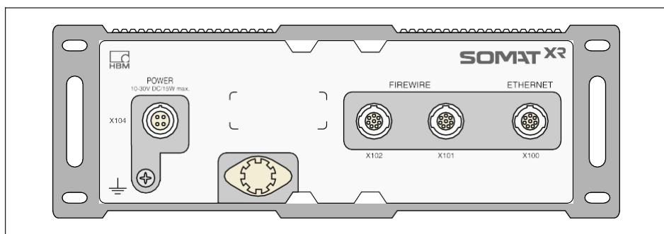
Todos os módulos MX têm uma parede traseira similar, com conexão à rede, duas conexões FireWire e uma conexão Ethernet.
