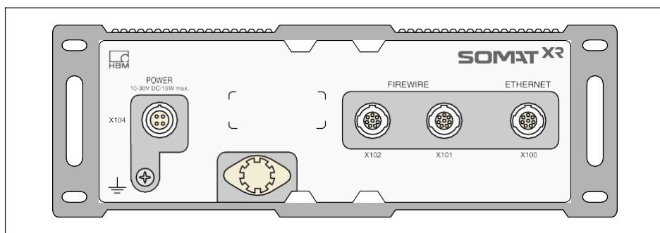
Alle MX-Module haben eine ähnliche Gehäuserückwand mit Netzanschluss, zwei FireWire-Anschlüssen und einem Ethernet-Anschluss.
