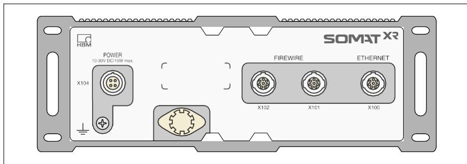
すべての MX モジュールは、電源コネクタ1個、FireWireコネクタ2個、 Ethernetコネクタ1個を備えた、類似したタイプの背面パネルを使用しています。
