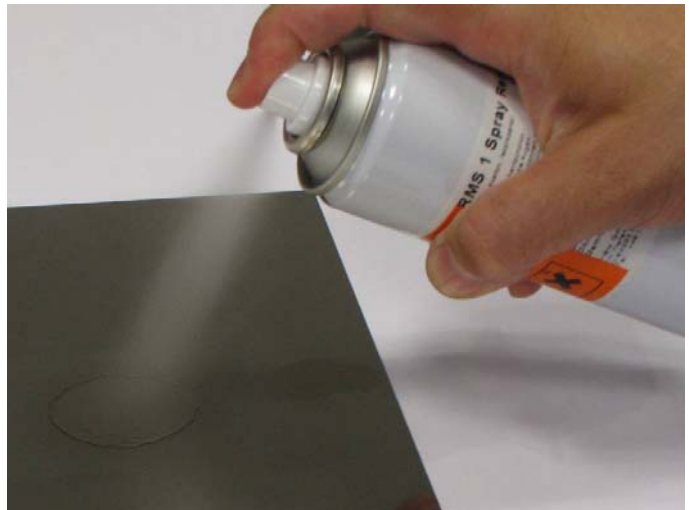
Abb. 1.1 Besprühen der Messstelle mit 1-RMS-Spray
