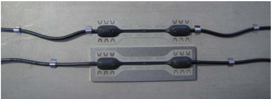
Abb. 3.1 Temperatur-kompensierte Dehnungsmessstelle mit Zugentlastung der Faserkabel.
