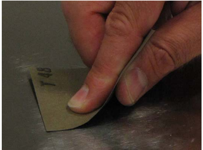
Abb. 1.3 Grobreinigung der Oberfläche des Messkörpers mit Schmirgelleinen
