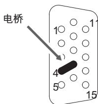
图8.9 接头的引脚排列，焊接面的视图
