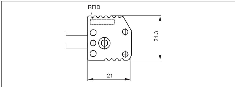
热电偶测量放大器的插入式连接
