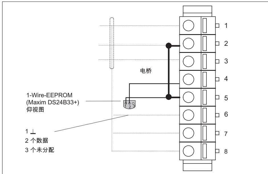
图8.16 连接插头的引脚排列，连接侧的视图
