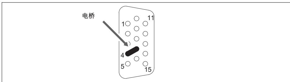
图8.2 接头的引脚排列，焊接面的视图
