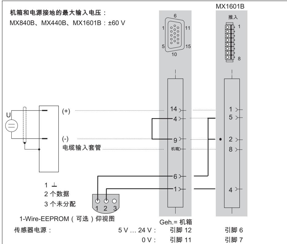
测量范围 $\pm 10\text{ V}$  兼容引脚，可通过软件进行参数化。
