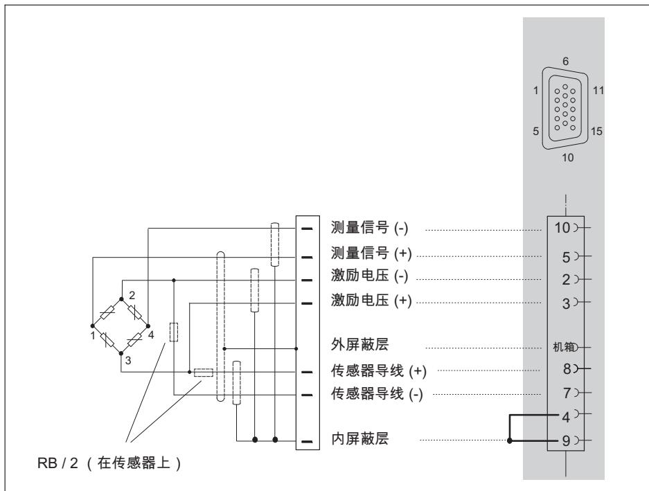
对于测量放大器 MX840B, MX440B, MX430B, MX410B 和 MX238B, 我们建议您在测量范围 较小、周围环境电磁干扰较强及所用电缆较长时采用这种连接技术。
