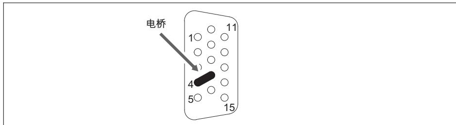
图8.5 接头的引脚排列，焊接面的视图
