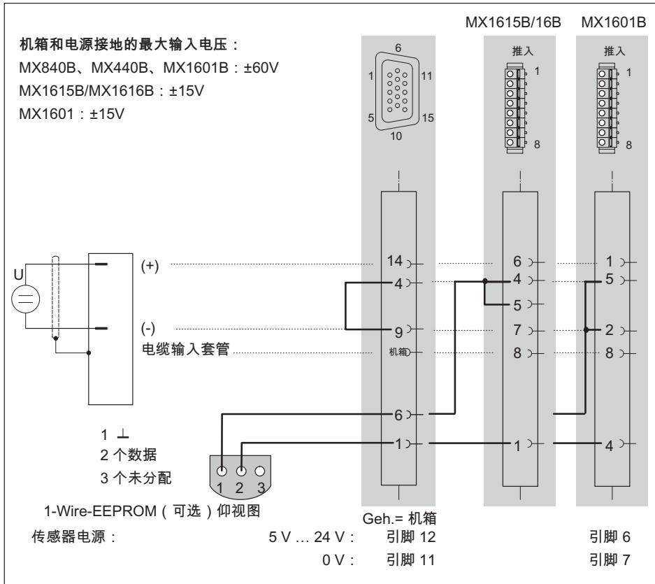
MX1601B : 仅 1-8 通道提供 5-24 V 的独立传感器电源。通道 9-16 可通过固定的传感器电源（模块电压 -1 V）激活。
