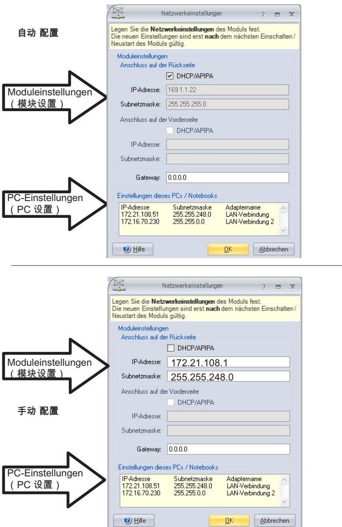
图7.5 模块直接连接时的设置示例
