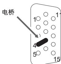
图8.7 接头的引脚排列，焊接面的视图
