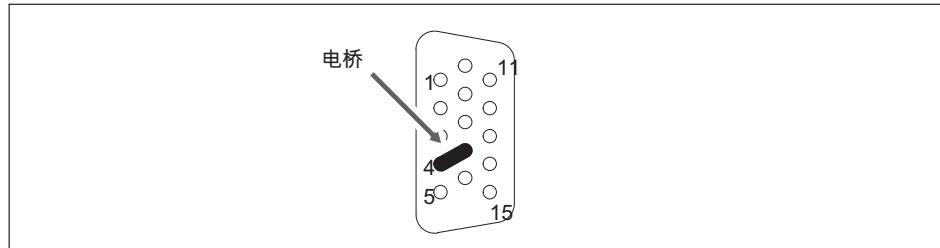
图8.11 接头的引脚排列，焊接面的视图
