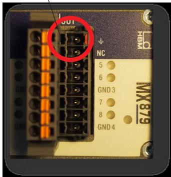
在为模拟输出进行插入式连接时，必须要切断尖端（编码）。
