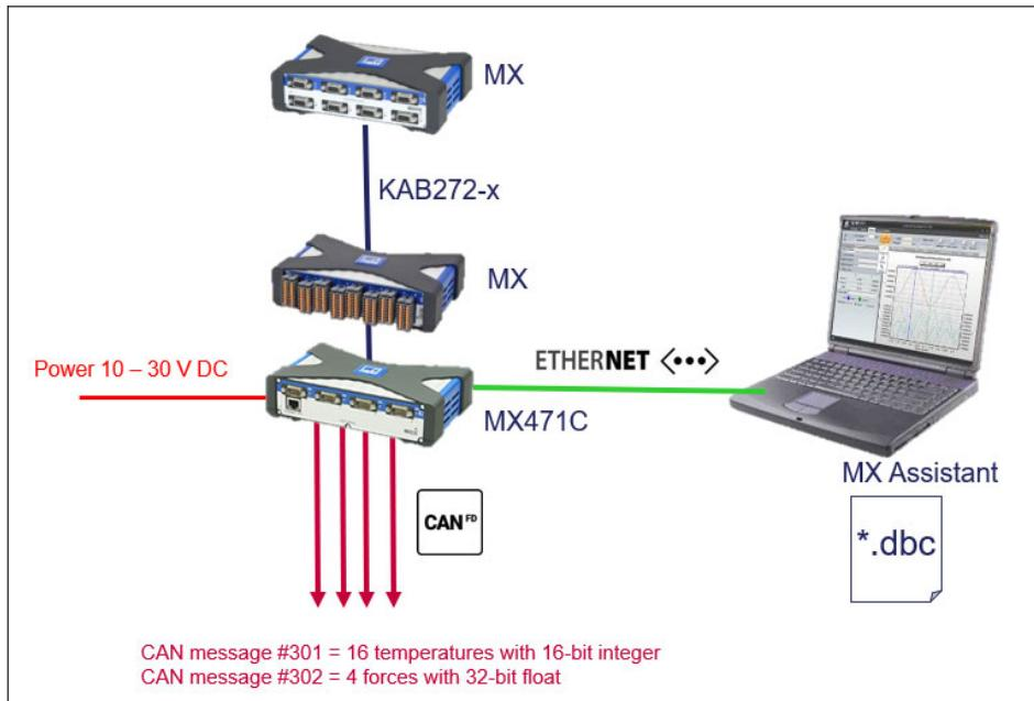
图7.9 输出至 CAN 总线 ( MX471B、每个接头 )
