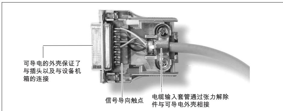
图8.1 电缆输入套管在插头中的导向
