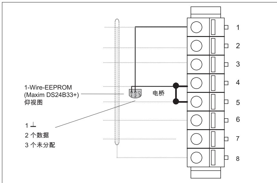
图8.18 连接插头的引脚排列，连接侧的视图
