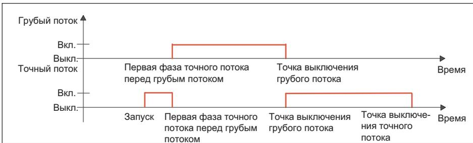
Рис. 10.8 Цикл наполнения при управлении клапанами «грубый/точный» с активацией первой фазы точного регулирования потока (см. также главу 10.2.26)
