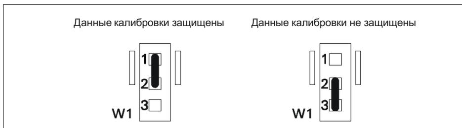
Позицию 1-2 перемычки W1, в которой данные калибровки защищены, при необходимости можно предохранить пломбой или печатью:
