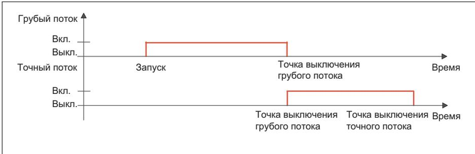
Рис. 10.7 Цикл наполнения при управлении клапанами грубого/точного потока
