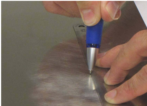
Abb. 2.6 Anzeichnen der Hilfslinien
