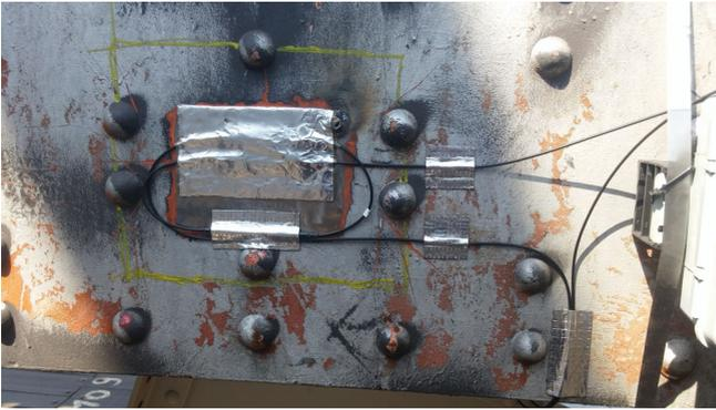
Abb. 2.39 Mit ABM75 geschützter Sensor
