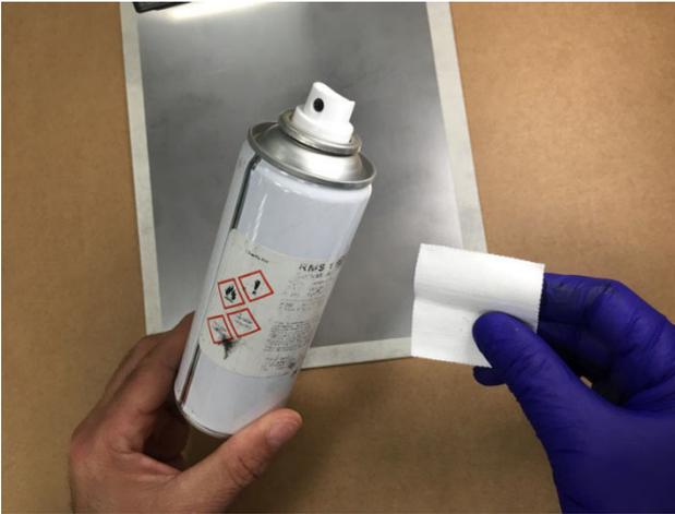
Abb. 2.6 Verwenden von Reinigungsmittel RMS1 und Vliesstoff-Pads
