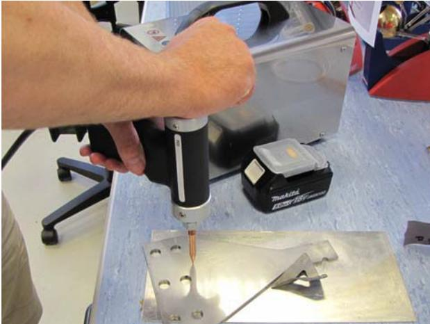
Abb. 2.16 Korrekte Schweißposition
