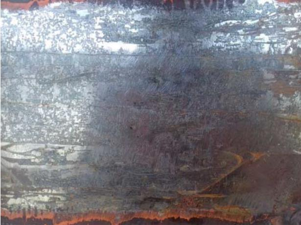
Abb. 2.3 *Unebene und rostige Oberfläche, ungeeignet für den anschweißbaren Sensor*
