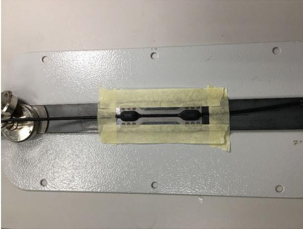
Abb. 2.12 Sorgfältiges Befestigen des Sensors sorgt für problemloses Anschweißen
