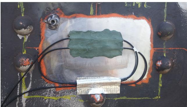
Abb. 2.38 Mit AK22 geschützter Sensor
