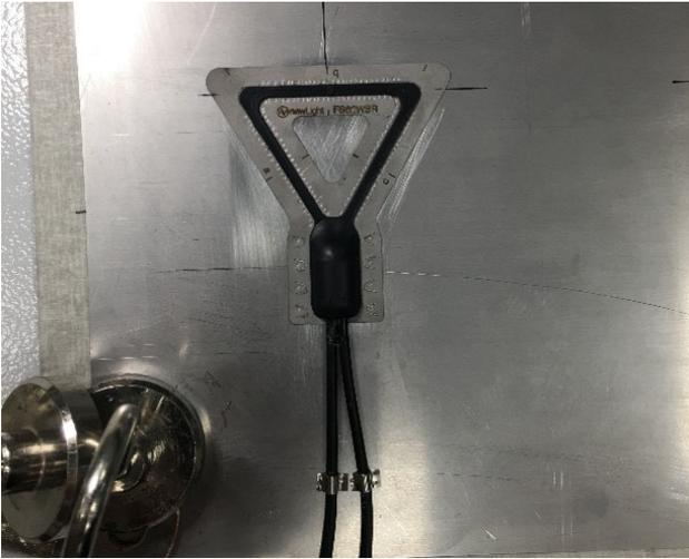
Abb. 2.31 FS62WSR mit Stahlschellen
