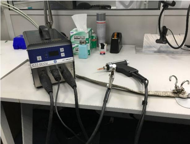
Abb. 2.13 Empfohlenes Punktschweißgerät
