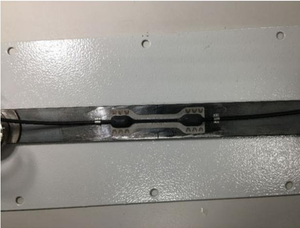
Abb. 2.21 Angeschweißter Sensor mit Stahlschellen
