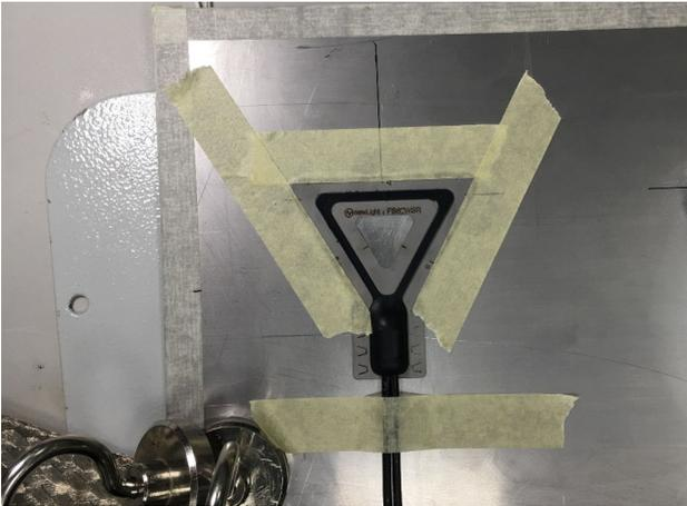
Abb. 2.25 Ausgerichtete und mit Abdeckband gesicherte Rosette FS62WSR
