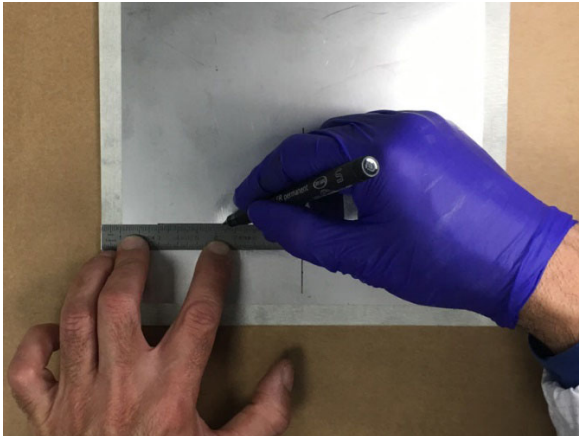
Fig. 2.9 Marquage de la position du capteur
