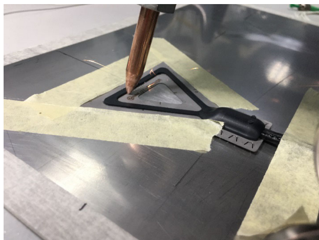
Fig. 2.30 Procédure de soudage de la FS62WSR
