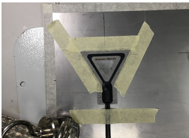
Fig. 2.25 FS62WSR alignée et fixée avec du ruban adhésif
