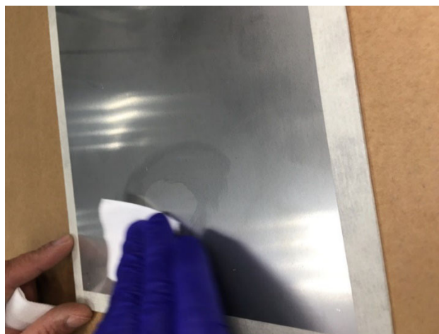
Fig. 2.7 Nettoyage de la surface
