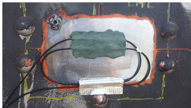
Fig. 2.38 Capteur protégé avec de l'AK22
