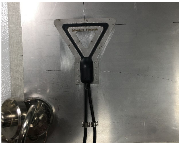
Fig. 2.31 FS62WSR avec clips en acier
