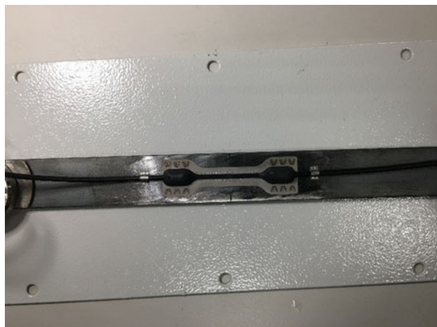
Fig. 2.21 Capteur soudé avec clips en acier
