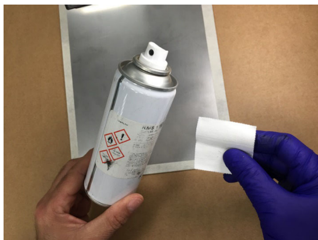
Fig. 2.6 Utilisation du nettoyant RMS1 et de morceaux de non-tissé
