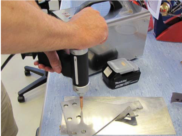
図2.16 正しい溶接位置
