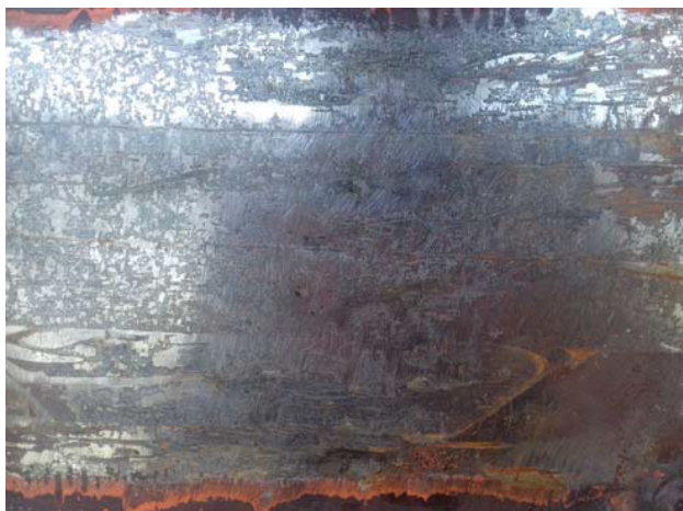
図2.3 センサの溶接には不適切なさびた表面
