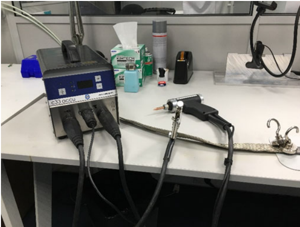
図2.13 推奨されるインパルス溶接装置
