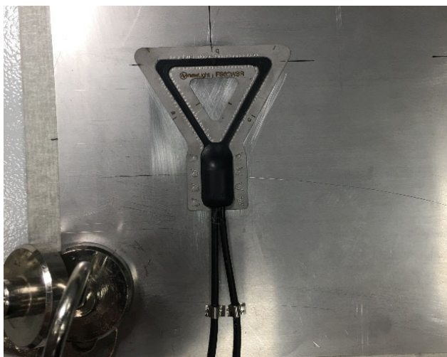
図2.31 スチールクリップを取り付けたFS62WSR
