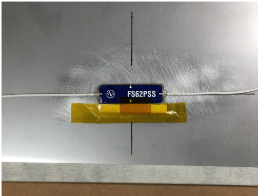
Abb. 2.9 Ausrichten und Platzieren des FS62PSS
