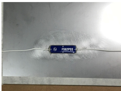
Fig. 2.15 Installation terminée de l'extensomètre optique
