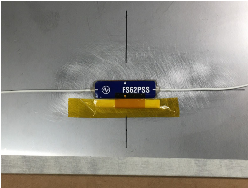
Fig. 2.9 Aligment et mise en place du FS62PSS
