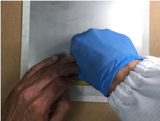
Fig. 2.22 Pression sur la rosette pendant 1 minute
