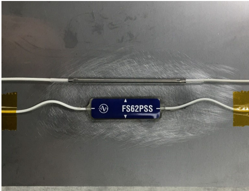
Fig. 2.25 Positionnement du capteur de température
