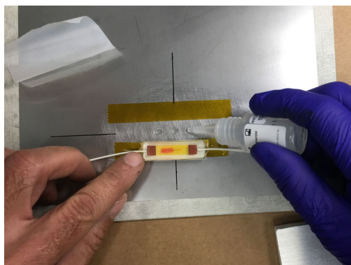
Fig. 2.11 Repli du FS62PSS et application de la colle CA80
