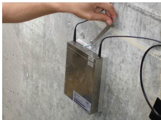
図2.12 六角ナットで締め付ける。
