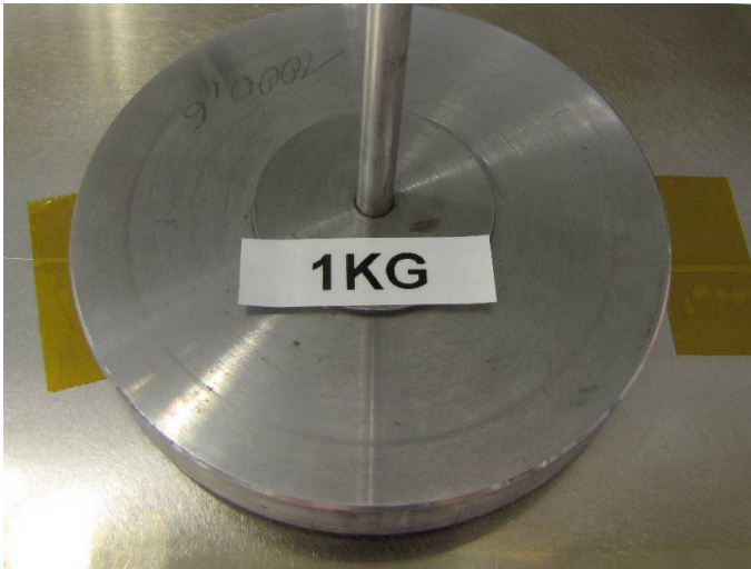
Abb. 2.11 Gewicht auf der FBG-Klebefläche der Glasfaser
