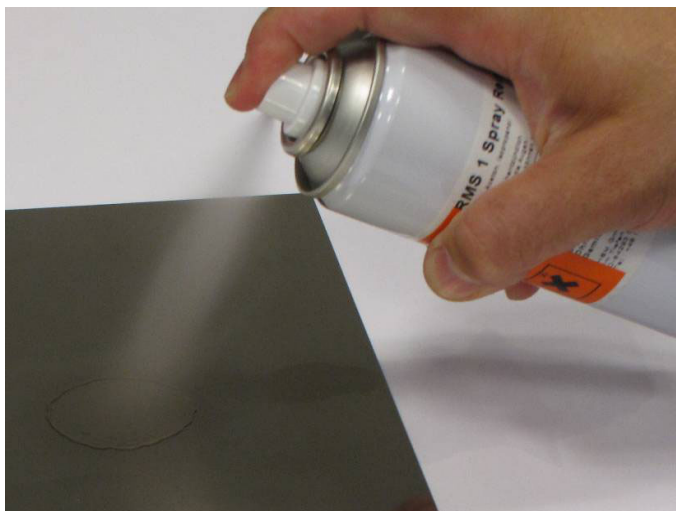
Abb. 2.1 Sprühen von 1-RMS auf die Probe
