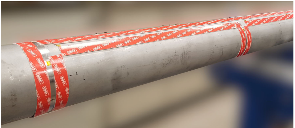
Abb. 2.20 Mit Schaumstoffband gebildete Aussparung entlang der Faser (optional).
