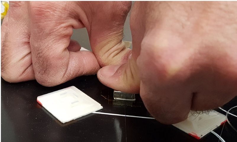
Fig. 2.19 Application d'une pression uniforme sur le réseau de Bragg
