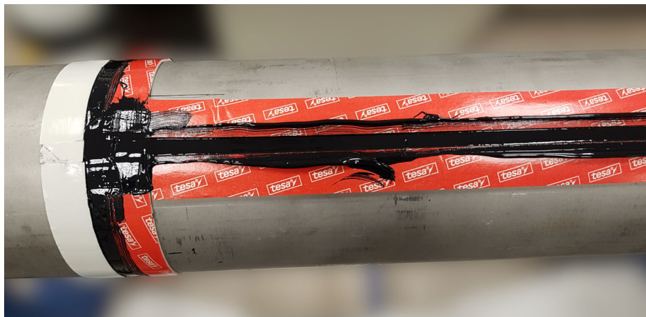
Fig. 2.21 Étalement de la colle avec une spatule
