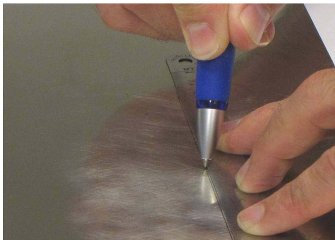
Fig. 2.6 Traçage des lignes de marquage
