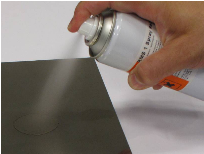
Fig. 2.1 Pulvérisation de 1-RMS sur un spécimen
