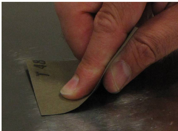
Fig. 2.3 Ponçage de la surface avec de la toile émeri
