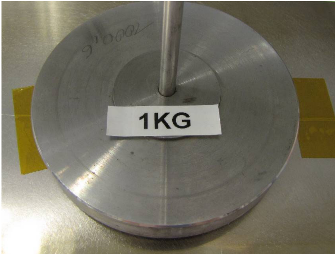
Fig. 2.11 Charge sur le dessus de la zone de collage de la fibre optique
