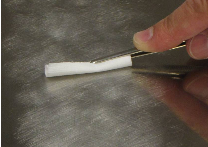
Fig. 2.4 Nettoyage de la surface d'installation poncée
