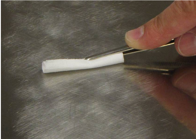
図2.4 粗面化した設置面の清掃
