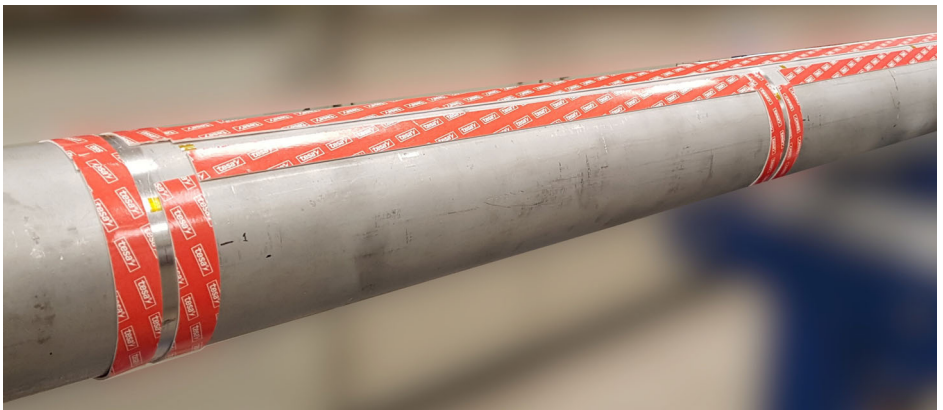
図2.20 フォームテープを使用してファイバに沿って溝を作成します（オプション）。
