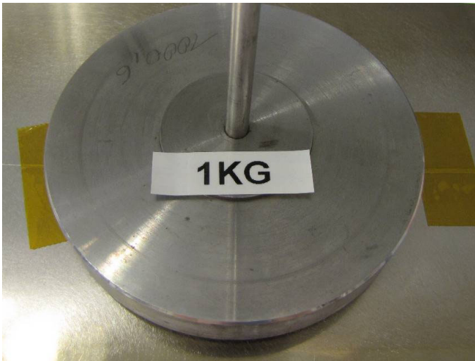
図2.11 光ファイバFBGセンサの接着面上に荷重をかける
