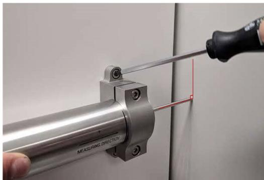
Fig. 2.6 Serrage des supports du capteur
