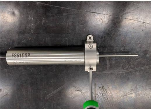
Fig. 2.5 Fixation des supports du capteur
