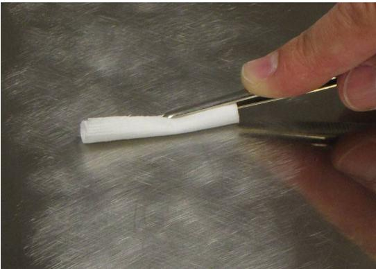
Abb. 2.4 *Reinigen der aufgerauten Installationsfläche*
