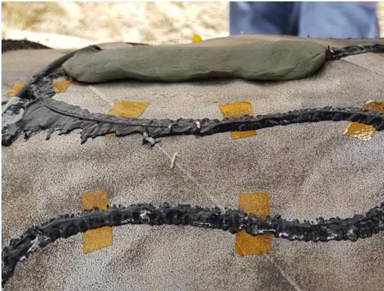
Abb. 2.16 Schützen des Sensors mit AK22
