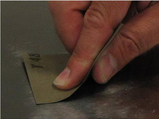
Abb. 2.3 *Aufrauen der Oberfläche des Messobjekts*
