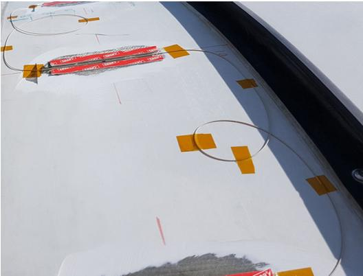
Abb. 2.18 Windung aus überschüssiger Faserlänge
