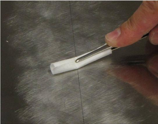
Abb. 2.7 Abschließendes Reinigen der Installationsstelle
