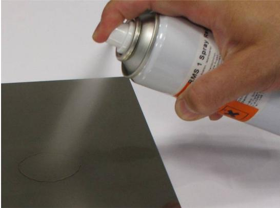
Abb. 2.1 Besprühen der Messstelle mit 1-RMS-SPRAY
