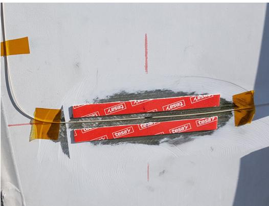
Abb. 2.8 Kleberahmen aus Montageband (optional)
