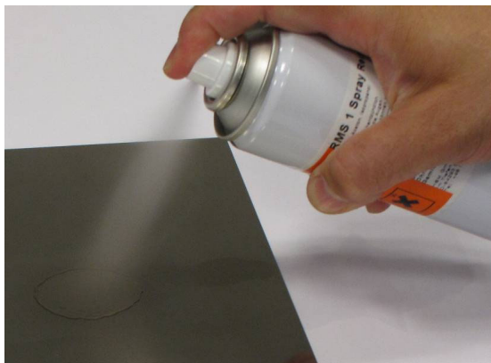
図2.1 1-RMS-SPRAYを使用して計測点に洗浄剤をスプレーする
