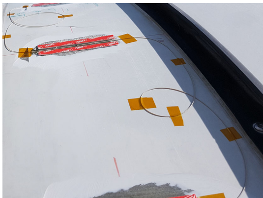
図2.18 ケーブルが長すぎる場合は、その一部をコイル状にする。
