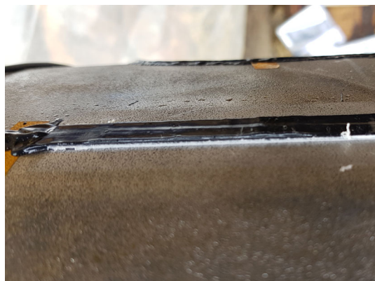
図2.15 テープを取り外した後の接着領域
