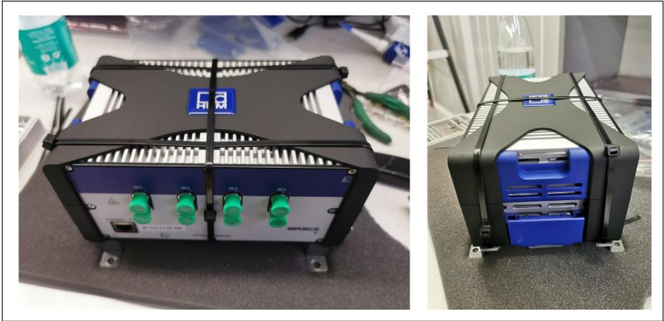
Fig. 3.18 Fixation supplémentaire à l'aide d'attaches de câble
