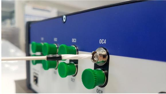
Fig. 3.30 Nettoyage de l'adaptateur d'un connecteur de l'interrogateur
