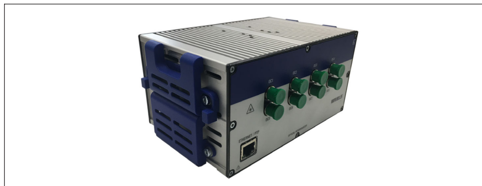
图3.13 无机箱保护的 MXFS
