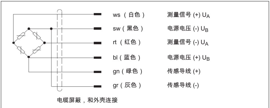
图8.1 接头布线采用 6 线电路
