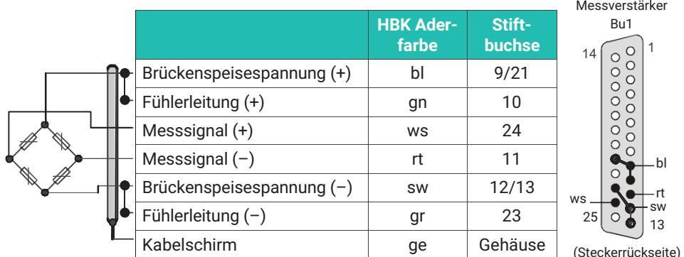
Abb. 6.2 Aufnehmeranschluss Speiseleitungen und Fühlerleitungen in 4-Leiter-Technik ohne Kabelverlängerung
