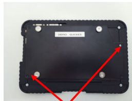
2 versiegelte Schrauben zur Erkennung von unbefugtem Öffnen
