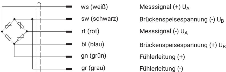
Kabelschirm, verbunden mit Gehäuse
