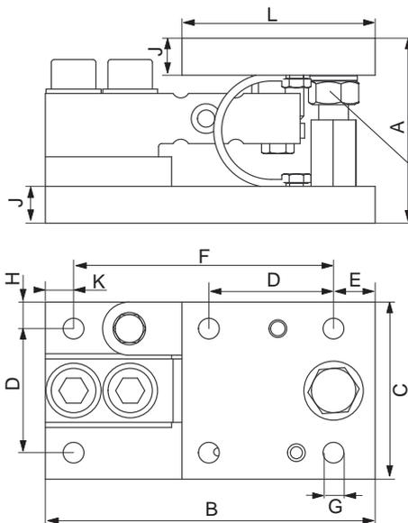
Anhebevorrichtung / Abhebesicherung
