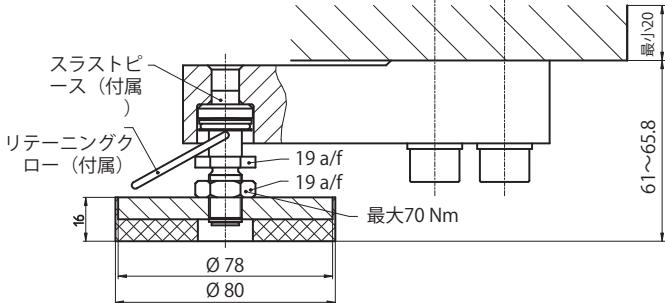
**HLCB/...T/ZEL - ラバー/金属ベアリング(亜鉛メッキ；HLCB/1.76T/ZELR、防錆材を使用)、HLC B用**
