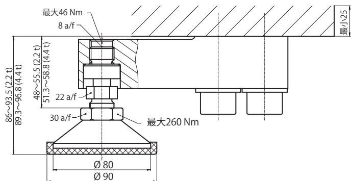
**HLCB/ZAK/1.76T - 高さ調節可能な振子式ローディングフット (ステンレススチール) HLC B ≤1.76 t 用**
