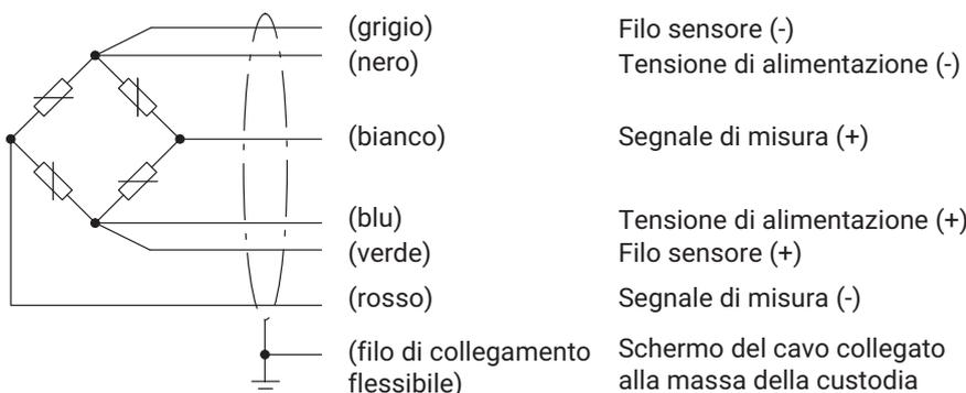
Con questo schema di cablaggio, la tensione di uscita all'amplificatore di misura è positiva se il trasduttore è caricato.
