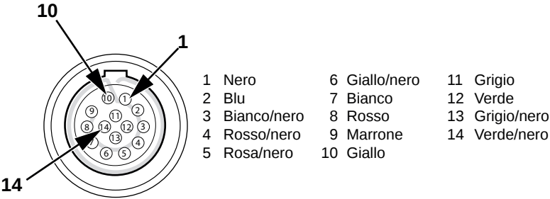
Figura 56: Numero di pin e colori fili (vista frontale)
