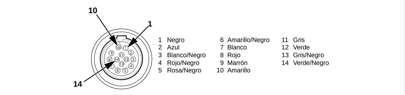
Figura 56: Número de pines y colores de los hilos (vista frontal)
