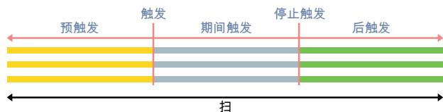
由一个触发信号定义，预触发和后触发以及（可选择）期间触发数据和/或停止触发信号。
