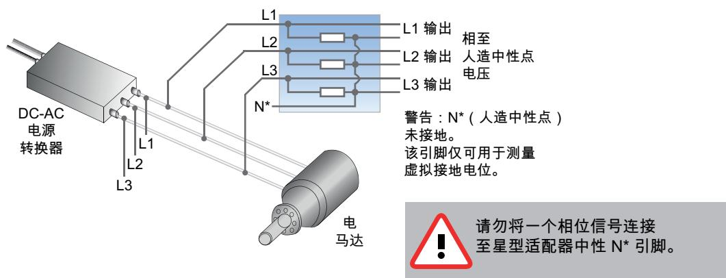
图 41: 三相代表采用人造星型适配器
