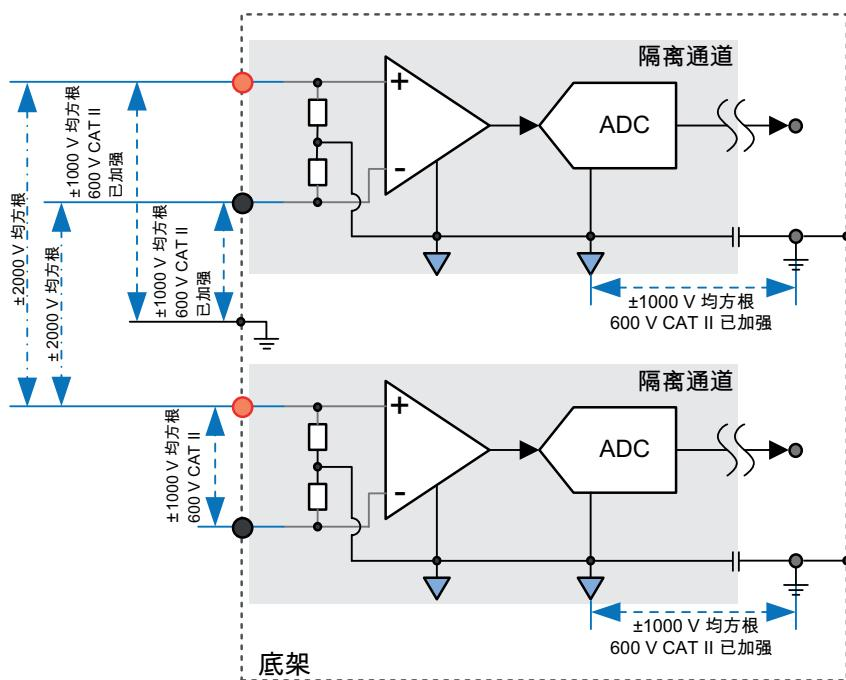
图 8: 隔离 1kV 卡概述
