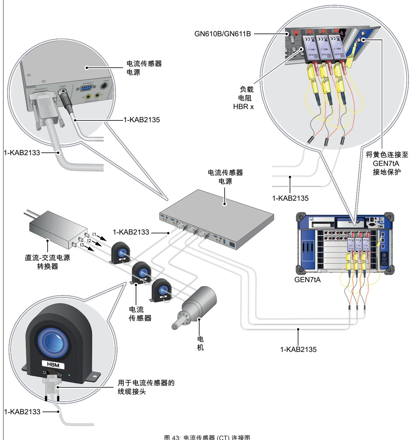
图 43: 电流传感器 (CT) 连接图
