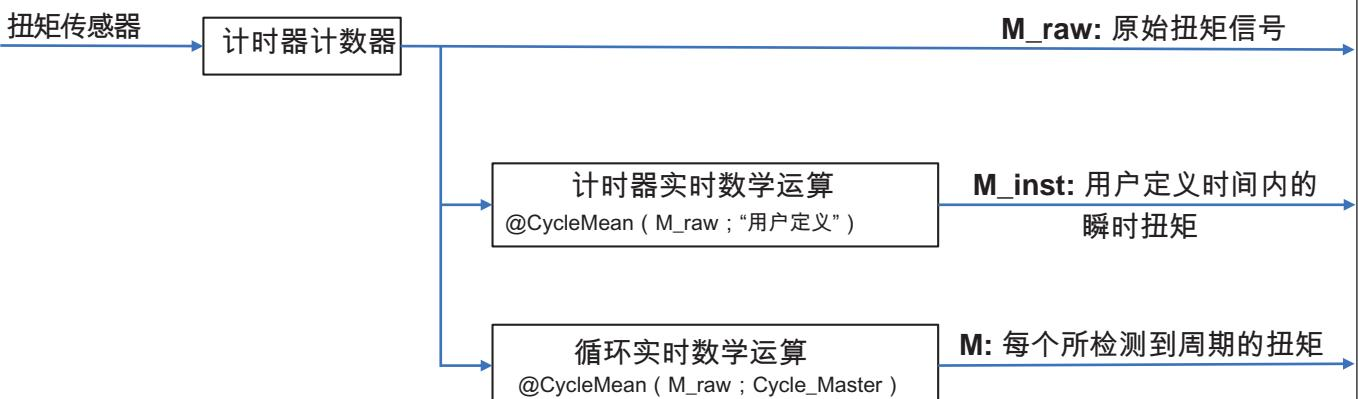
图 36: 同时动态的和精确的转矩计算
