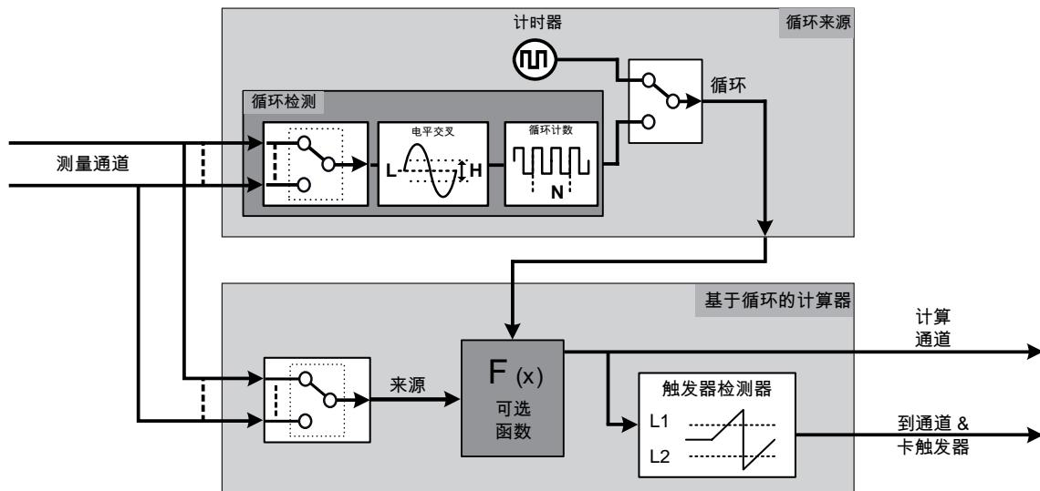
图 37: 基于实时循环的计算器
