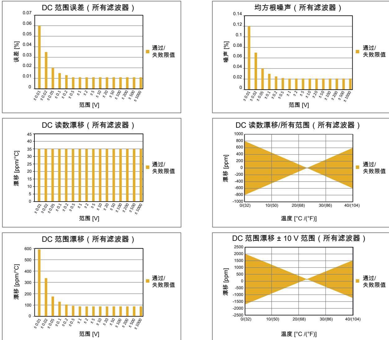
图 7: 使用的所有滤波器的电压规格
