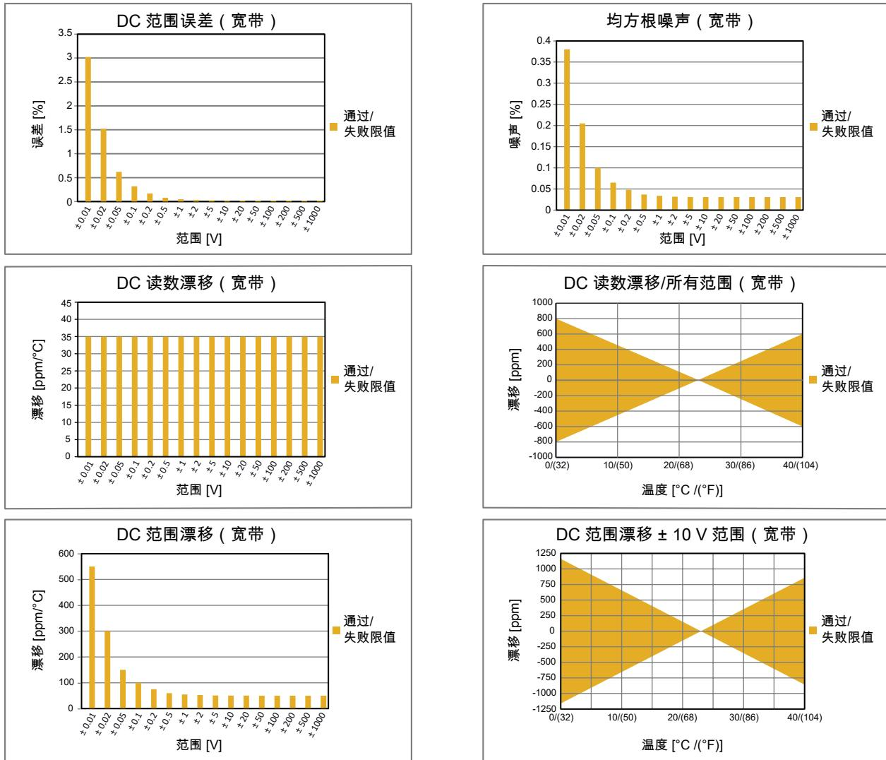
图 6: 宽带电压规格
