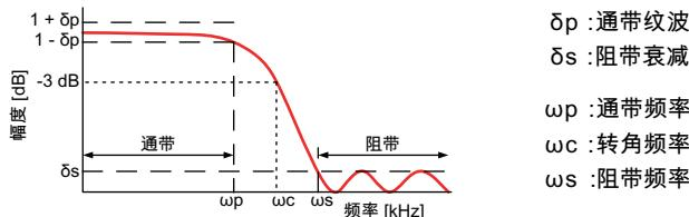
选择贝塞尔 IIR 滤波器时，始终有模拟贝塞尔抗混叠滤波器和数字贝塞尔 IIR 滤波器的组合。
