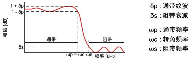
选择椭圆 IIR 滤波器时，始终存在模拟巴特沃斯抗混叠滤波器和数字椭圆 IIR 滤波器的组合。
