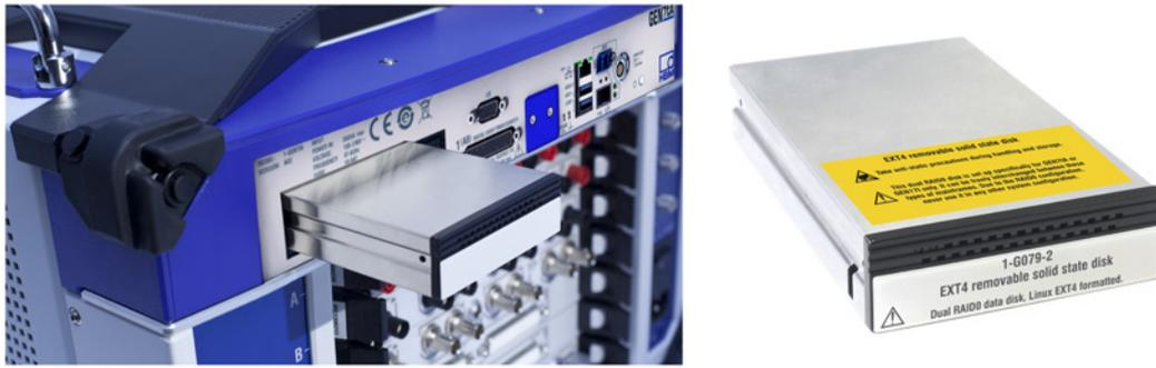
**Figura 1.19:** Ejemplo de SSD en soporte de disco parcialmente introducido en el GEN7tA (izquierda) y soporte de disco integrado en el SSD (derecha)
