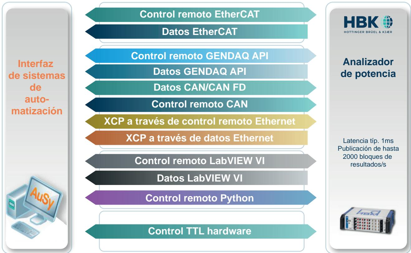
**Figura 38:** Interfaces disponibles entre sistemas de automatización y dispositivos básicos Genesis HighSpeed
