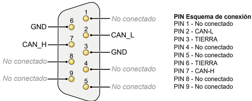
Figura 35: Esquema de conexión D-Sub
