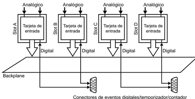
**Figura 15:** Diagrama de bloques de Evento digital/Temporizador/Contador
