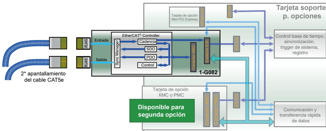
Figura 22: Diagrama de bloques de la tarjeta EtherCAT®
