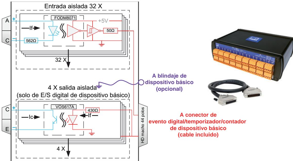
Figura 29: Diagrama de bloques y foto
