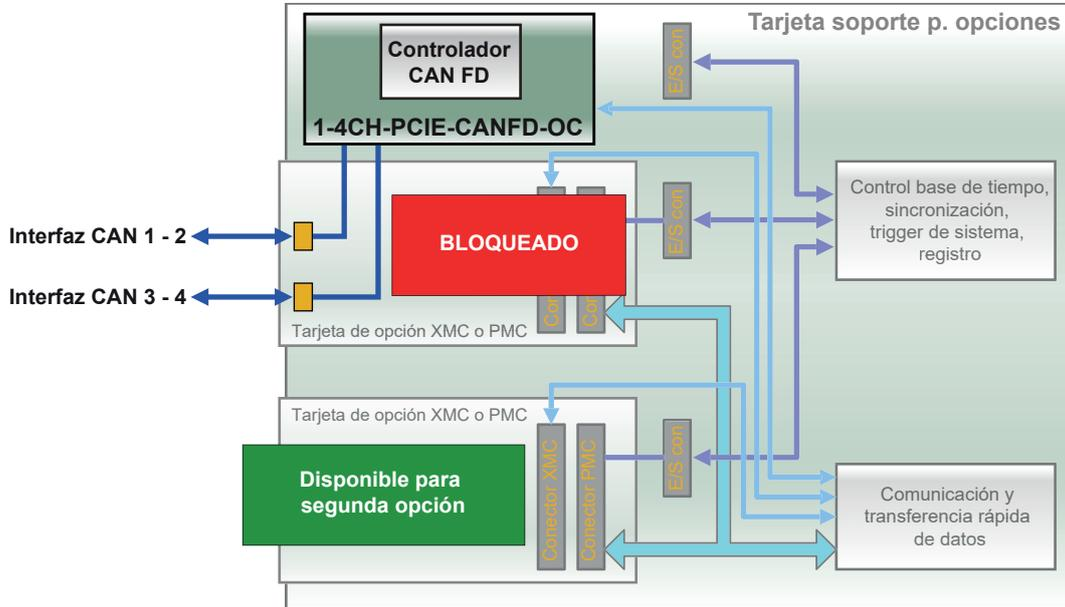
Figura 23: Diagrama de bloques de 1-4C-PCIE-CANFD-OC (se requiere G081)
