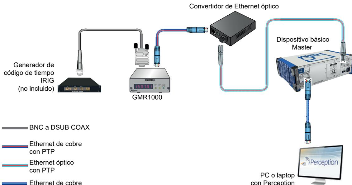
**Figura 30:** Ejemplo de configuración de la sincronización horaria IRIG
