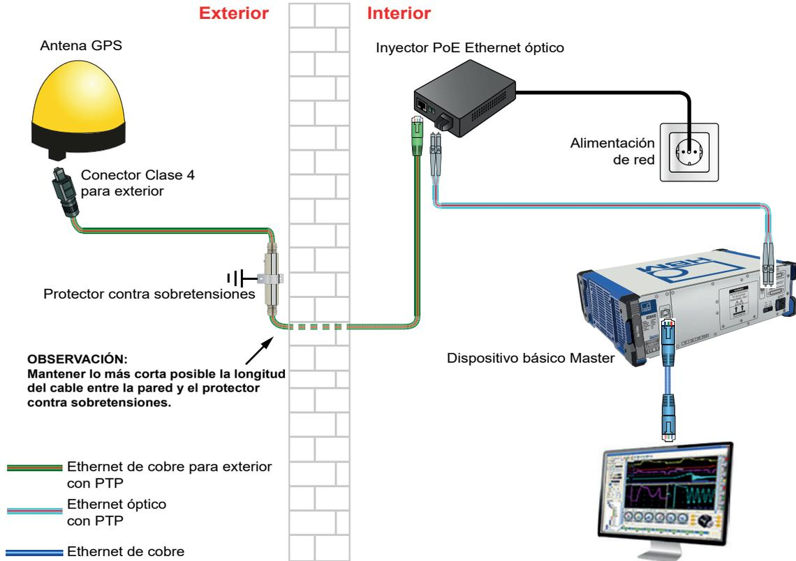
**Figura 31:** Ejemplo de configuración de la sincronización de hora GPS
