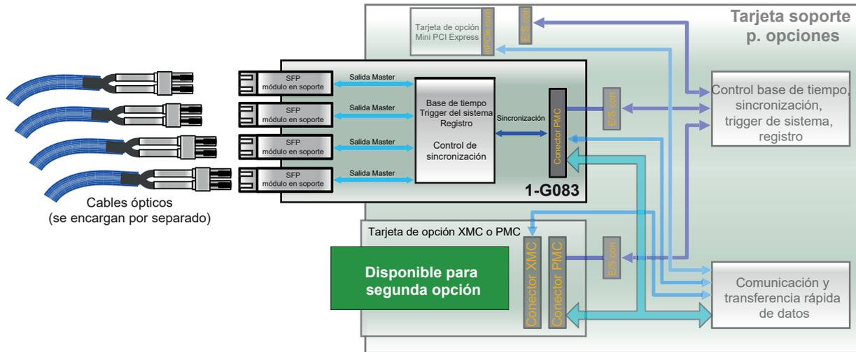
Figura 21: Diagrama de bloques de tarjeta master de salida (opción G081 requerida)
