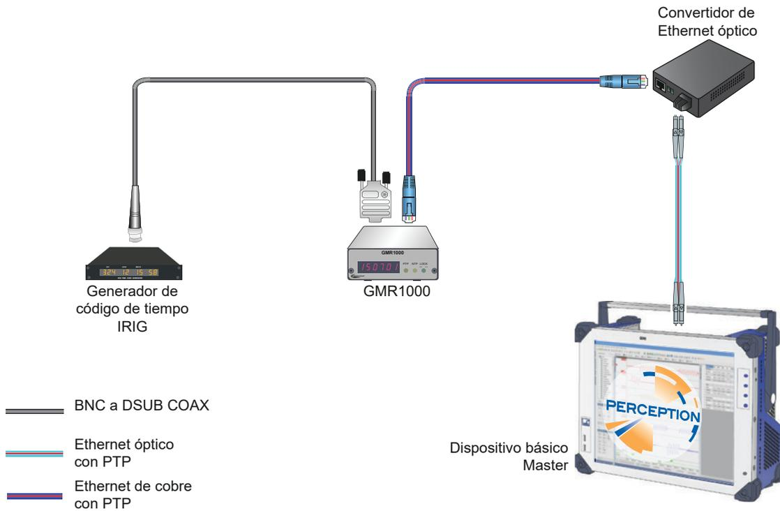
**Figura 1.31:** Ejemplo de configuración de la sincronización HORARIA IRIG
