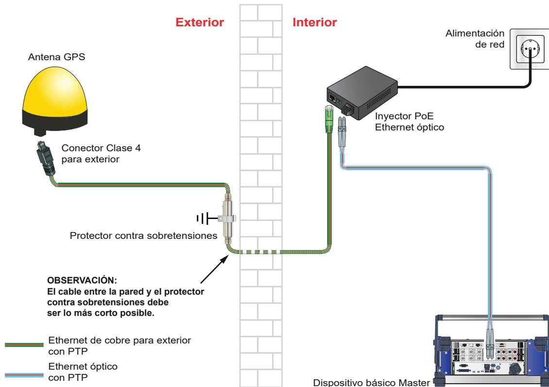
Figura 1.32: Ejemplo de configuración de la sincronización de hora GPS
