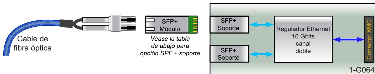
**Figura 1.22:** Diagrama de bloques de la tarjeta Ethernet de 10Gbit, fibra óptica (se requiere G081)
