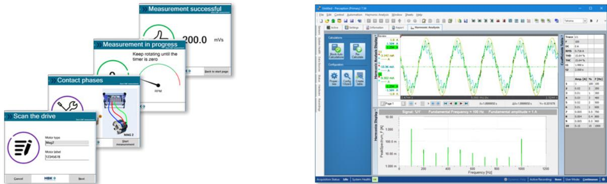
**Figura 1.39:** Ejemplos Perception CSI BackEMF (izq.) Análisis de armónicos (der.)
