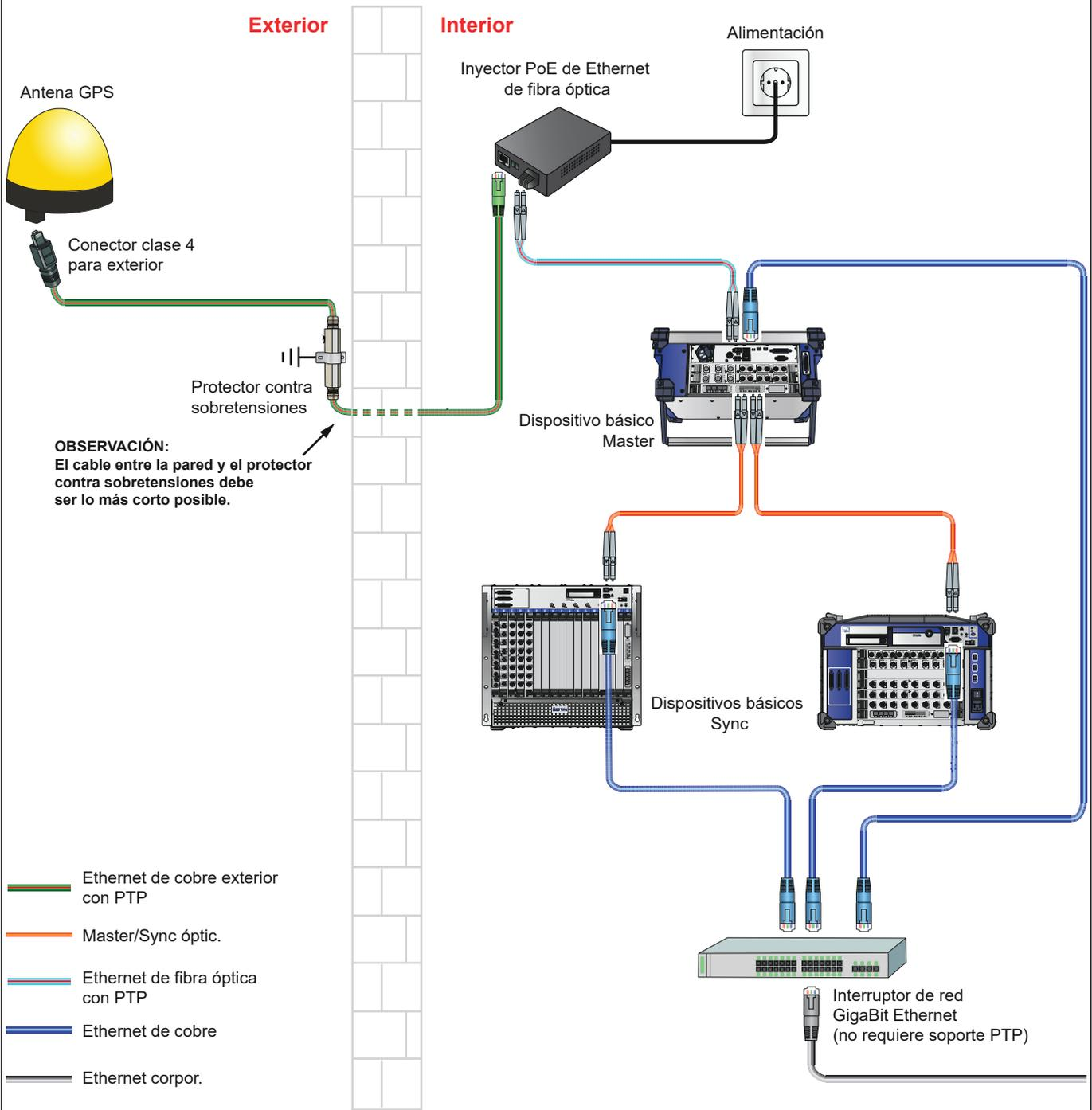
**Figura 1.33:** Configuración GPS para dispositivo básico anclado y con dispositivos básicos Sync conectados en modo Master/Sync
