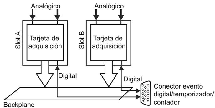
**Figura 1.14:** Diagrama de bloques de Evento digital/Temporizador/Contador
