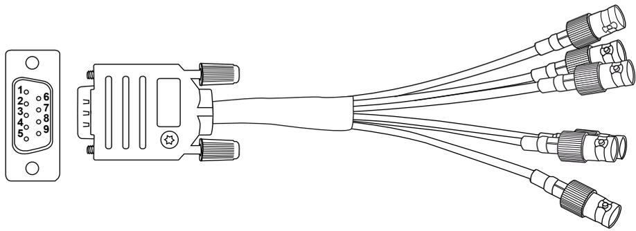
**Figura 1.13:** Esquema de conexión de cable de conexión repartidor
