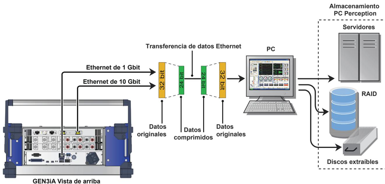
Figura 1.10: Vista de conjunto del almacenamiento de datos remoto
