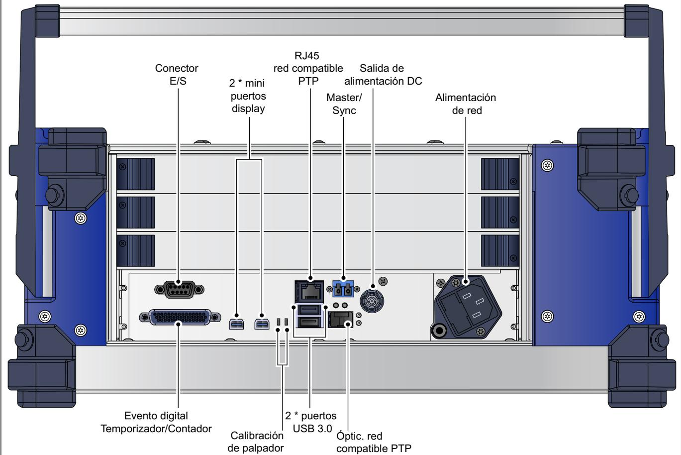
Figura 1.7: Visión de conjunto de las conexiones
