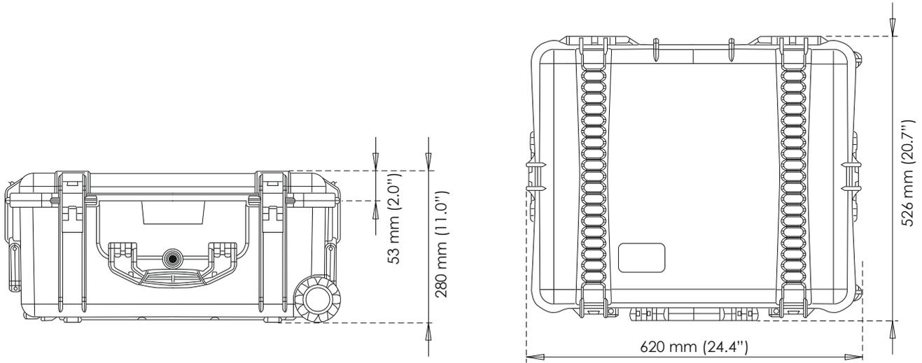
**Figura 1.35:** Maleta de transporte rígida reutilizable, con ruedas y asa de transporte
