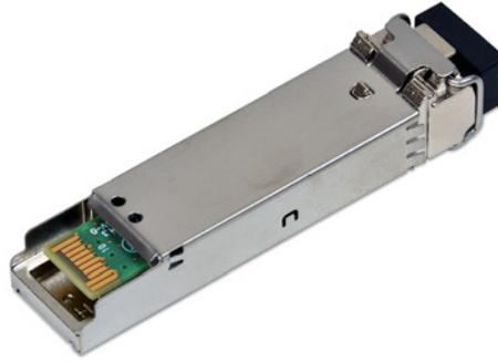
Figura 1.23: Módulo SFP+ de red óptica de 10 Gbit 850 nm
