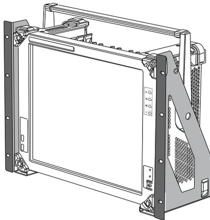
**Figura 1.36:** Kit de montaje en rack GEN3iA
