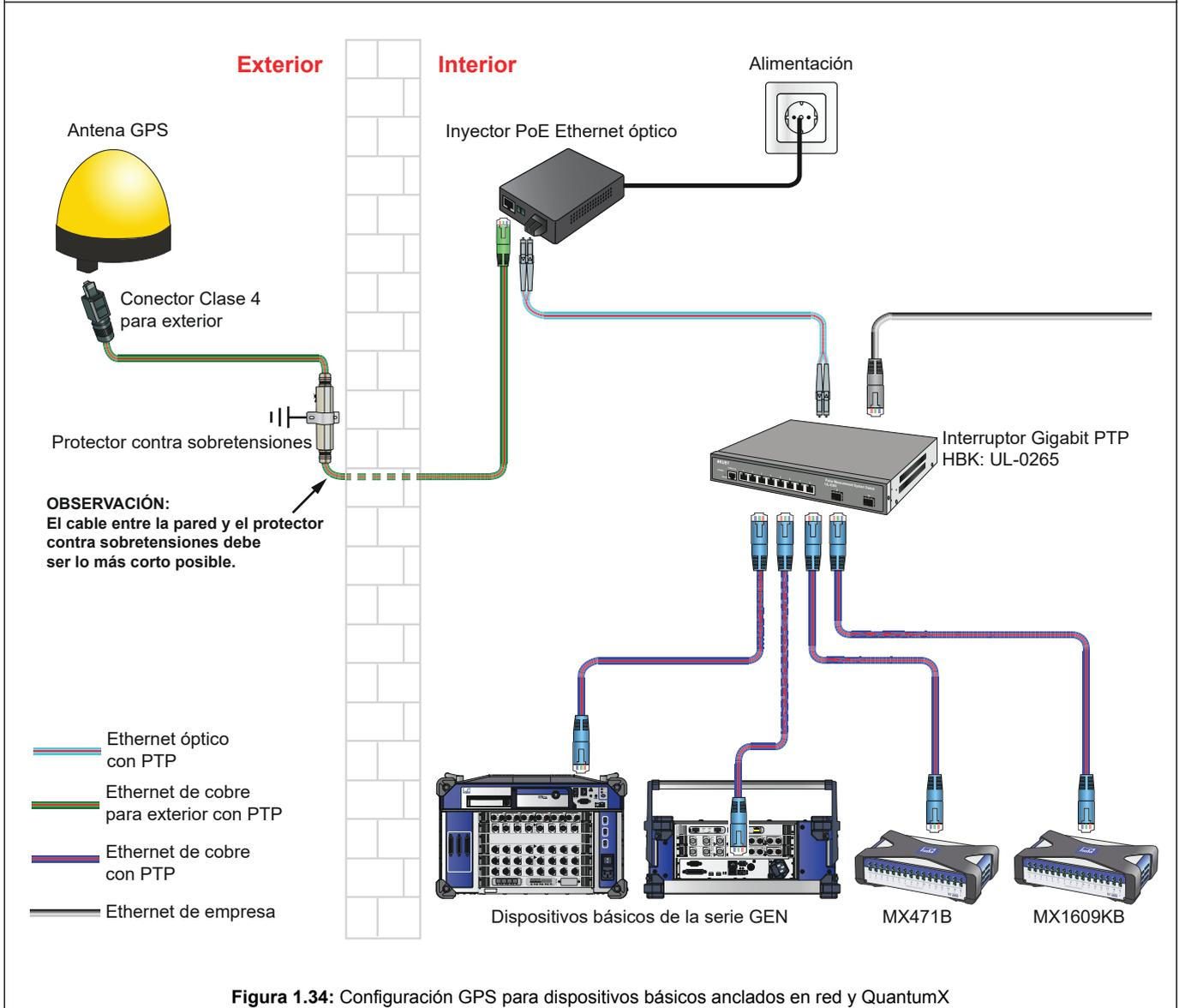
**Figura 1.34:** Configuración GPS para dispositivos básicos anclados en red y QuantumX
