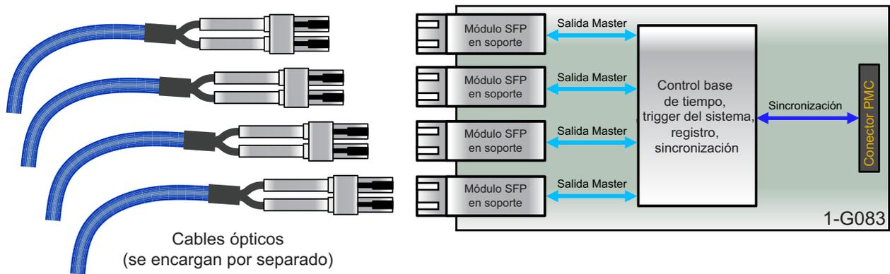
Figura 1.21: Diagrama de bloques de tarjeta master de salida (opción G081 requerida)
