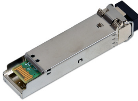
图 1.23: 10 Gbit 光学网络 SFP 模块 850 nm
