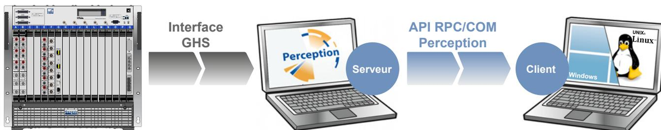
Figure 1.42 : Schéma de principe DCE/RPC
