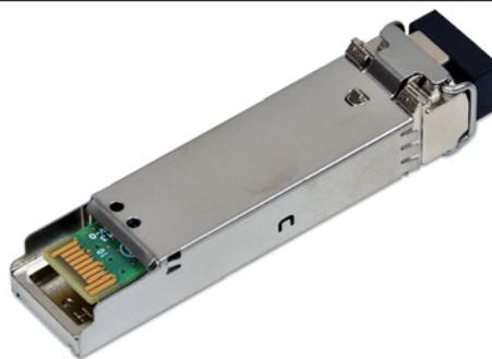
Figure 1.24 : Module SFP+ à réseau optique 10 Gbit 850 nm
