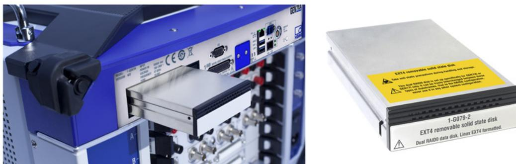
**Figure 1.18 :** Exemple de SSD dans un support de disques partiellement inséré dans le GEN7tA (à gauche) et SSD intégré dans un support de disques (à droite)
