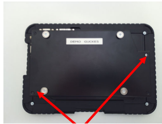
2 versiegelte Schrauben zur Erkennung von unbefugtem Öffnen
