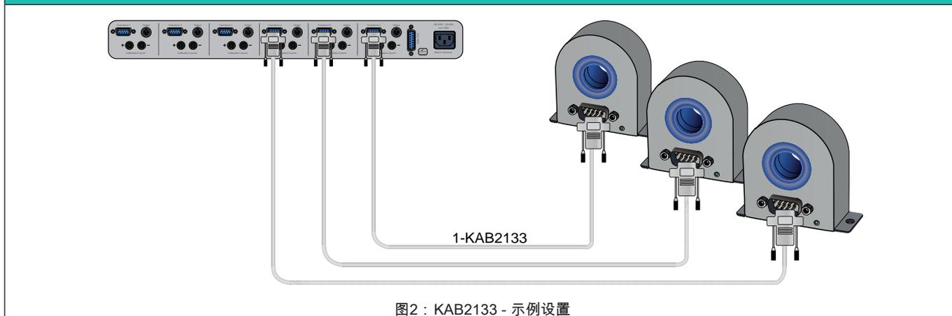
KAB2133 : D-Sub 9 电流传感器连接电缆
