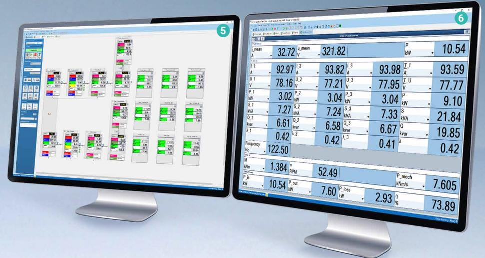
Perception ePower 소프트웨어를 사용하여 몇 번의 마우스 클릭만으로 전력 분석기를 작동할 수 있습니다. 또한 장치를 하나의 범위, FFT 분석기 그리고 raw 데이터 수집을 위한 DAQ로 전환시킵니다. 사전 정의되고 사용자 정의 공식으로 실시간으로 분석하고, 확인 및 인증을 위한 포스트 프로세스에서 재분석하고, 데이터를 Matlab 또는 LabVIEW 같은 다른 패키지로 전송하는 능력이 있습니다. 그리고 다중 모니터링 기능으로 PC에서 지원하는 만큼의 모니터에 이 모든 정보를 표시할 수 있습니다.
