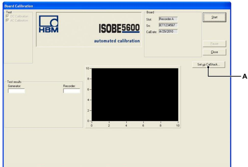
**Abbildung 1.12:** Fenster "Board Calibration" (Kalibrierung der Platine) für den Sender
