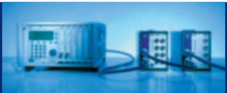
Extension d'un système MGCplus avec des modules MGCsplit – simple et très rapide !
