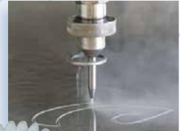
Foto: Wasserstrahlschneiden Döffles
