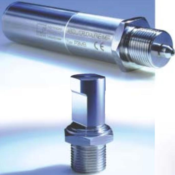
Grâce à sa construction particulière monolithique la chambre de pression est hermétique et ne présente donc aucune soudure sur l'élément de mesure, le capteur P3MBP (Blue Line) offre des propriétés exceptionnelles, même pour les plages de pressions les plus élevées.
