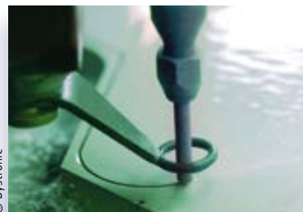
Höchste Drücke präzise steuern beim Wasserstrahlschneiden
