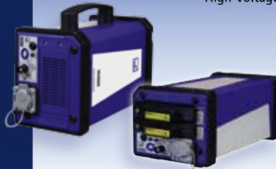
Les appareils de type 6600 sont des numériseurs isolés pour les systèmes d'acquisition de données GEN. Ils sont alimentés par batterie ou par une alimentation isolée de 10 kV. La transmission des signaux par fibres optiques permet d'acquérir des signaux à des vitesses d'échantillonnage pouvant atteindre 100 Méc/s.
