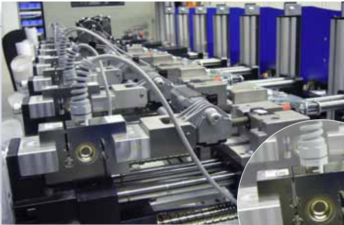
Kraftaufnehmer S9M im Prüfstand von C. Rob. Hammerstein
