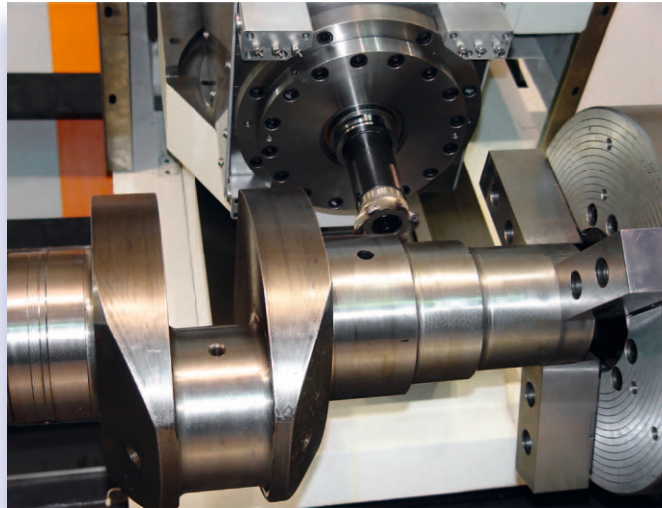
クランクシャフトの機械加工プロセスは非常に複雑で、最高レベルのプロセス安全性が要求されます。
