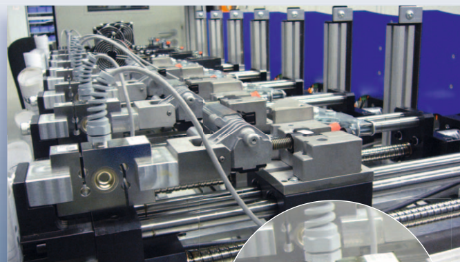
C. Rob. Hammerstein の試験機で 使用されるS9M力変換器
