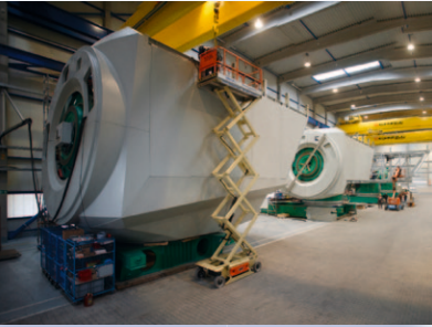
洋上風力発電プラントに使用する実装済みのナセル
