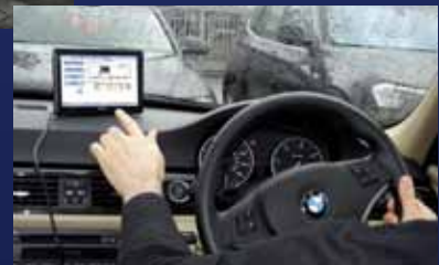
Ein komplettes Messsystem im Gepäck: Die im Kofferraum erfassten Messdaten werden dem Fahrer direkt angezeigt.
