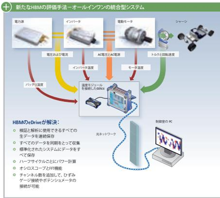
複数の計測機器の同期は、それだけで手間がかかり間違いを起こしやすいものです。Genesis HighSpeedシリーズを使用した計測データの収集は、HBMのデジタルトルクセンサと完全にフィットします。この組み合わせを使用すれば、インバータと電動モータを非常にダイナミックかつ正確にテストすることができます。各チャンネルにつき1秒に最大200万回の計測を最長1時間、連続的に実施しても問題ありません。
