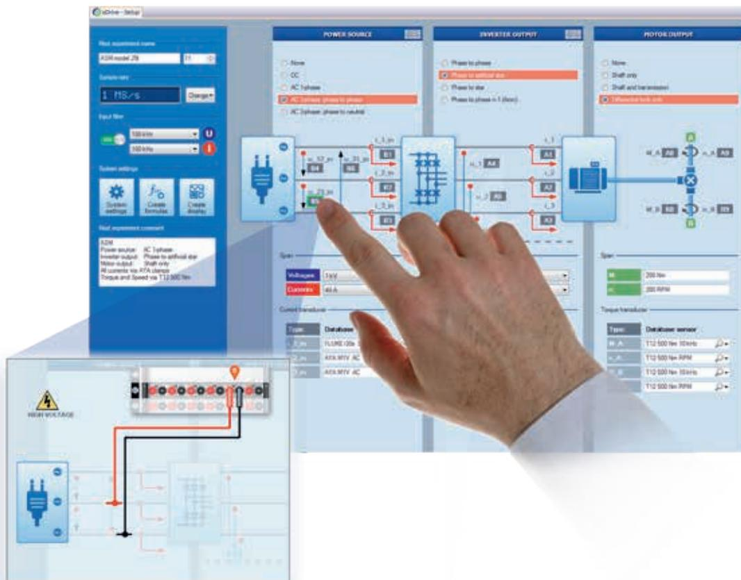
セットアップメニューはお客様の計測タスクをシミュレートし、電気駆動装置を機能ブロックとして視覚化します。例えば、電源、接続のタイプ、使用する電流センサ、サンプリングレートなどを選択するだけで設定は完了です。
