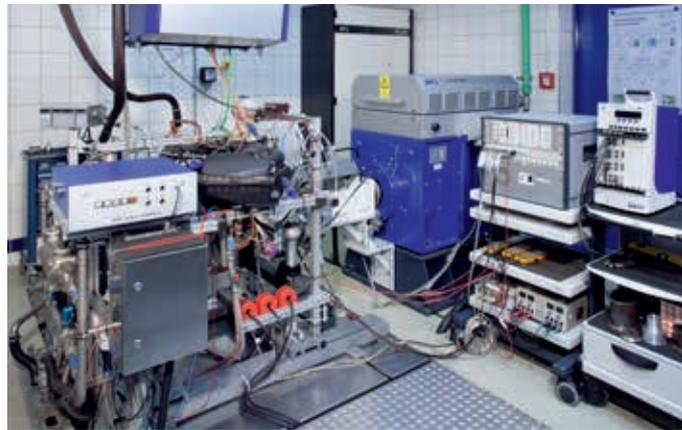
Équipement d'essai et de mesure HBM sur un banc d'essais de moteurs hybrides, à l'université technique de Darmstadt, institut vkm (institut pour les machines motrices à combustion interne et les moteurs de véhicules).
