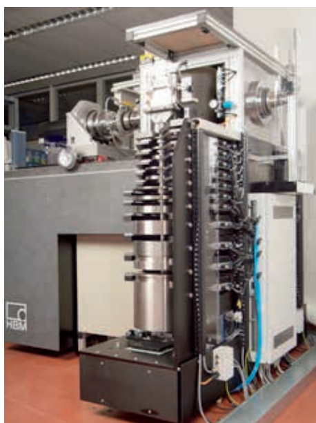
Высококачественные испытательные стенды собственной калибровочной лаборатории HBM обеспечивают надежность результатов измерений T40.
